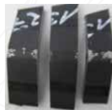
Zobrazení 2: Frontální pohled na tři vzorky „GRANIT“ po ohybové zkoušce. Nejsou vidět žádné praskliny.
