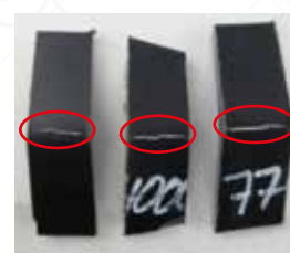
Zobrazení 4: Frontální pohled na tři vzorky „Originální výrobce“ po ohybové zkoušce. Praskliny viditelné na všech vzorcích.
