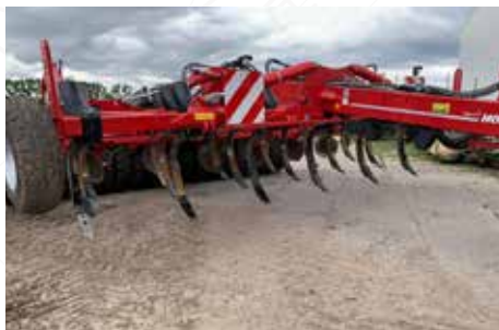
Zobrazení 1: Plně smontovaný zkušební kultivátor
