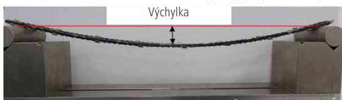
Obrázek 1: Experimentální nastavení pro měření průhybu pilových řetězů
